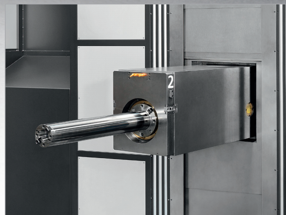
▲ MLX Q: Integrated quill boring system. MLX Q: Sistema integrato canotto di alesatura.
