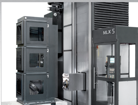
▲ MLX: Automatic head changing system. MLX: Sistema di cambio testa automatico.
