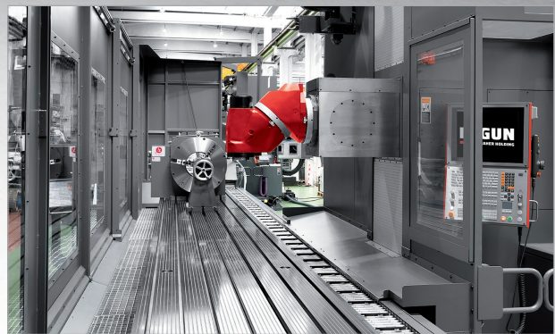
▲ CM table / Tavola CM: (X traverse + 1.500 mm) x 1.100 mm. (Corsa X + 1.500 mm) x 1.100 mm.
